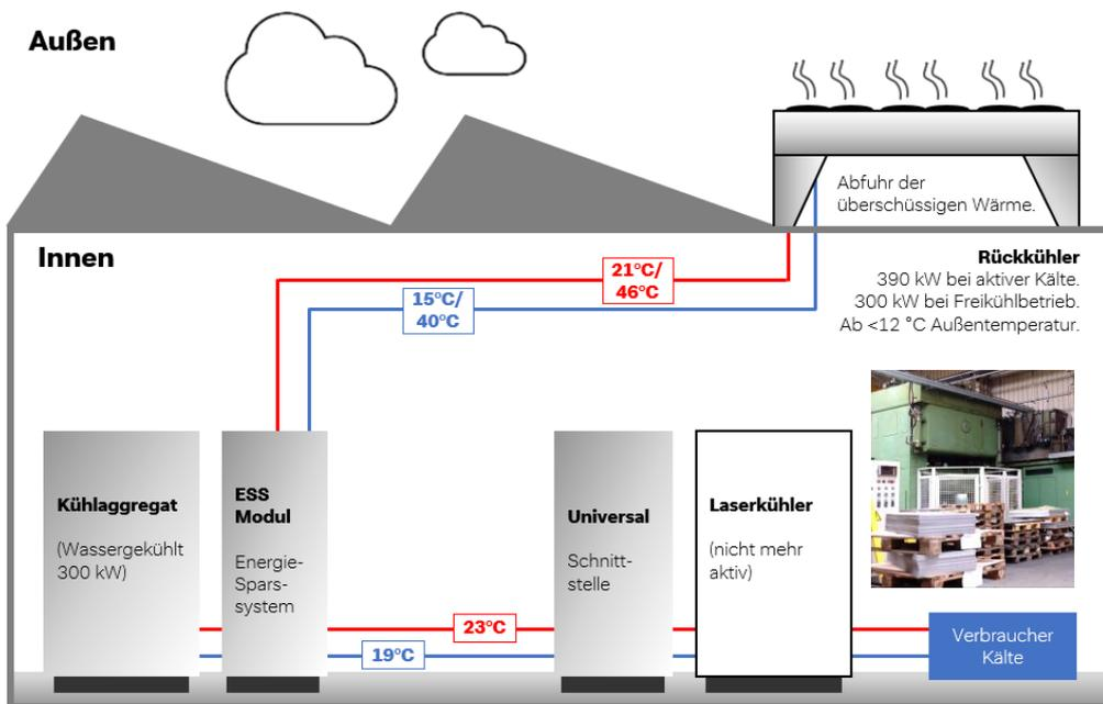
Installation einer zentralen Kühlanlage (Plug&Play). 300 kW bei 19 °C Prozesswasser-Temperatur inklusive einer Energiesparschaltung und passive Kühlung ab einer Außentemperatur von 12 °C.
