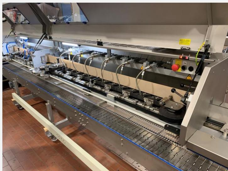
In der ersten Bandstation erfolgt die Erwärmung der Klebestelle über Heizelemente auf Erweichungstemperatur. Damit die empfindliche Außenfläche des Beutels nicht an den heißen Teilen kleben bleibt und beschädigt wird, läuft ein mit Teflon beschichtetes Stahlband mit. Anschließend werden die Klebeflächen mit gerillten Andruckrollen (Crimp-Rollen) zusammengepresst und in der zweiten Bandstation unter die Erweichungstemperatur des Klebers abgekühlt.
